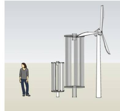
Dans les installations domestiques, deux familles d'éoliennes existent : celles à axe vertical, et celles à axe horizontal (« hélices d'avion ») Dans les deux cas, leur hauteur totale varie entre 6m et 15m ou peuvent avoir des mécanismes de fixations aux toitures et garde-corps. Certaines sont stabilisées par des haubans (câbles), d'autre par des fondations et fixations rigides du mât.
